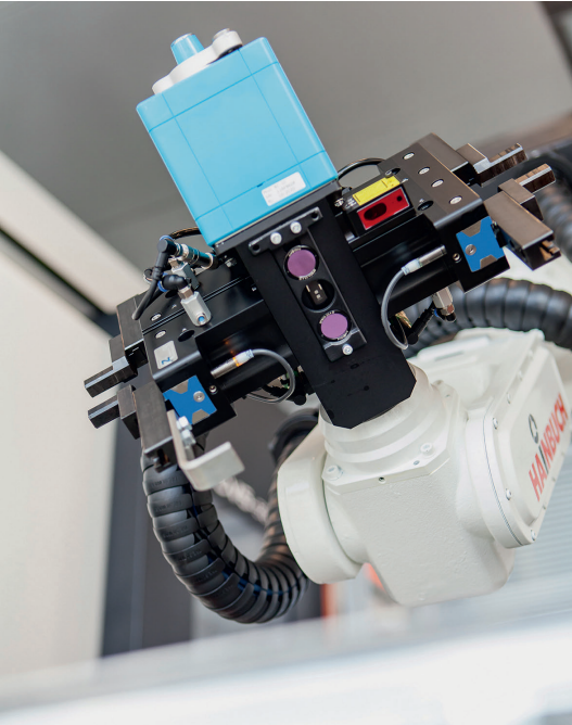
2 Die Werkstücke werden durch das 3D-Kamerasystem im flexibel einstellbaren Greifer zuverlässig erfasst © Hainbuch
